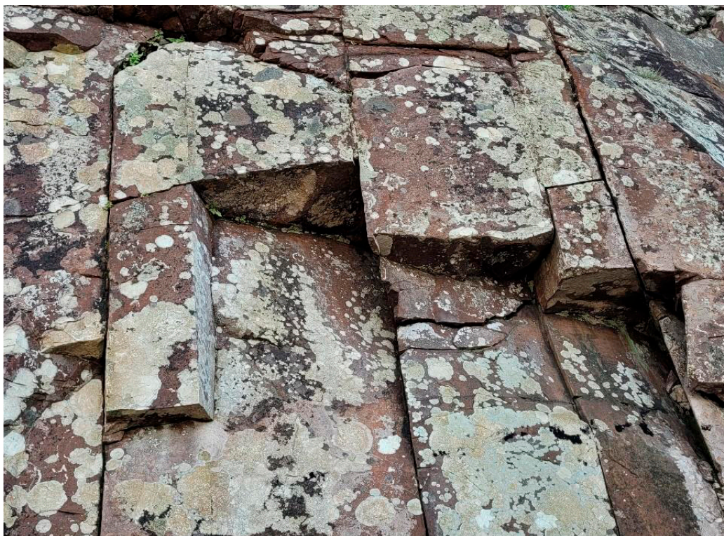
Figura 22 -Sistemas de fraturas que se inter cruzam nas mais diferentes direções com presença constante em todos os maciços rochosos da área pesquisada. Fonte: Elaborado pelos autores.
