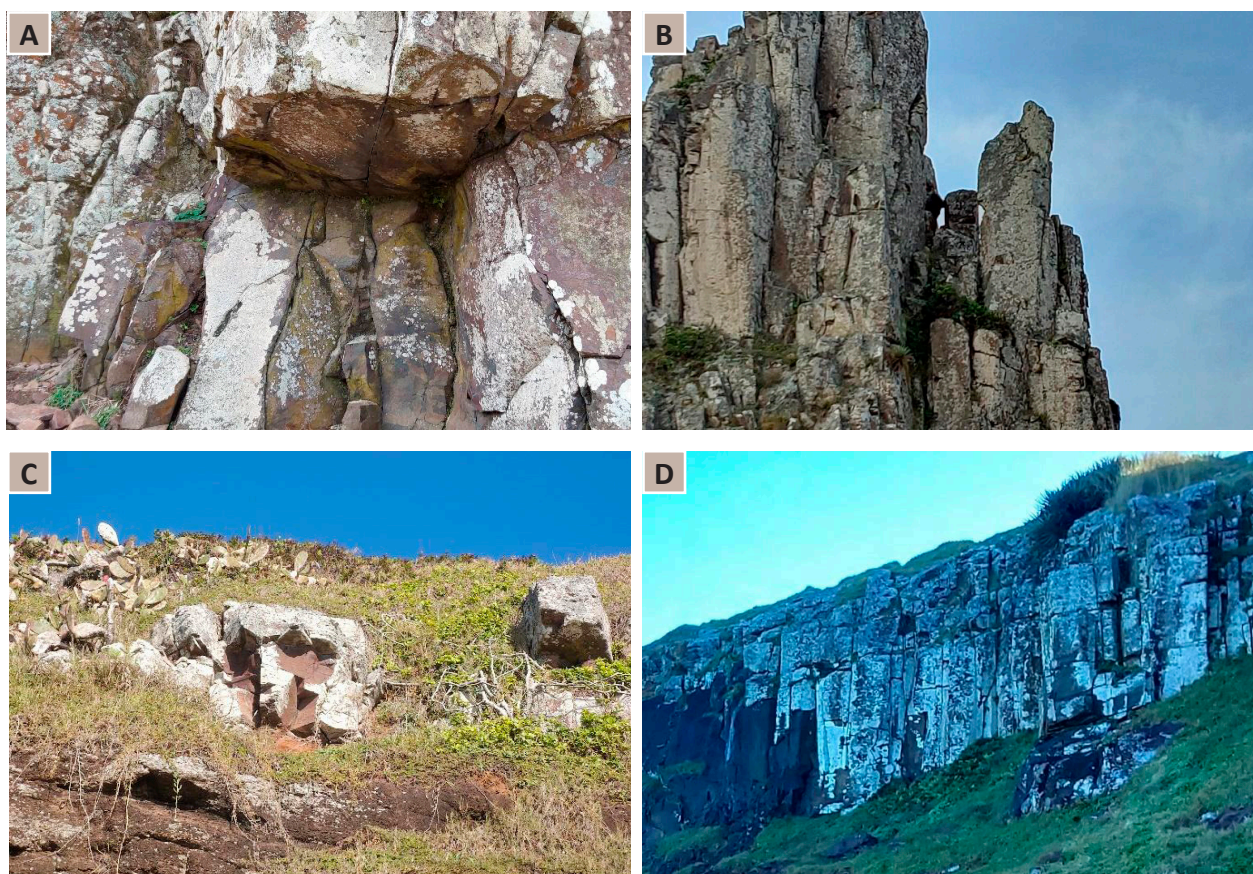
Figura 20 - Tipos de riscos geológicos de grau muito alto associados a movimentos de blocos em pontos de visitação turística: (A) - queda; (B) - tombamento; (C) – rolamento; (D) – deslocamento. Fonte: Elaborado pelos autores.
