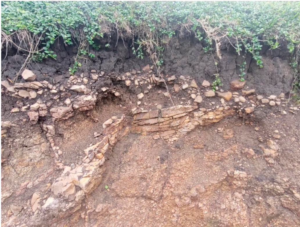
Figura 41 - Imagem de perfil do solo residual acima da borda do paredão, onde os distintos horizontes pedológicos podem ser diferenciados. Fonte: Elaborado pelos autores.
